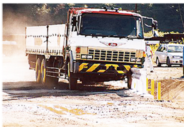
トラック衝突時（直接基礎上）
